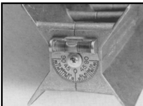
Een ingebouwde graadverdeling met waterpas maakt nauwkeurig meten mogelijk.
